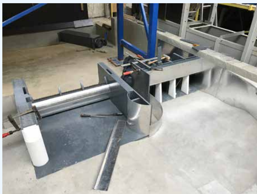
Modèle réduit en cours de construction par l'ULiège pour les exutoires de dévalaison du site de Grands-Malades.
